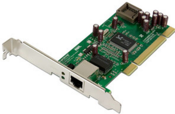
Imagen 12.1. Ejemplo de una placa de red.
