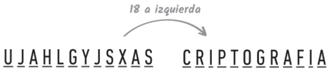
Imagen 19.2. Al desplazar cada letra 18 posiciones a la izquierda “Ujahlgysxas” se transforma en “Criptografía”.
