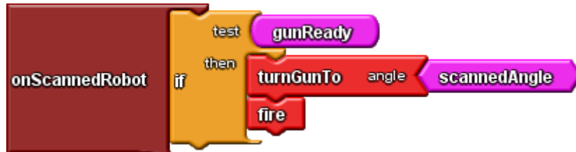
Figura 15 - Estrategia ofensiva: El robot ataca cuando detecta un robot en el campo de batalla
